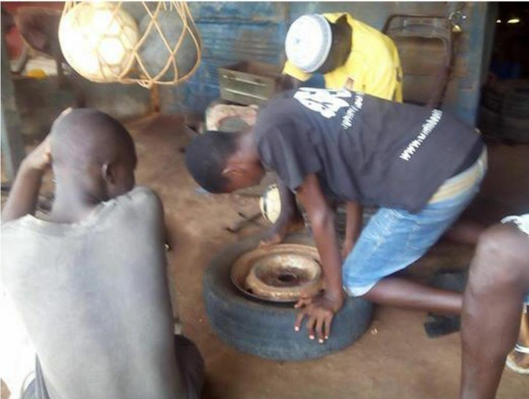
Il gommista di Nhacra è un portento. Con l'aiuto di due ferri e una pompa da bicicletta, ripara anche ruote di camion. Rintraccia il chiodo con l'aiuto di una brocca d'acqua e l'ottura con il mastice. L'operazione va a buon fine. Al ritorno ripareremo anche l'altra gomma .
